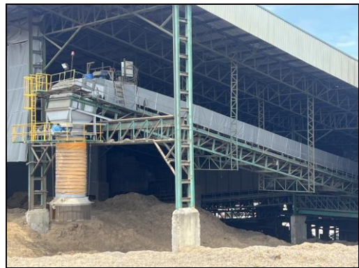
รูปที่ 4 ระบบสายพานลำเลียงแบบครอบคลุม
