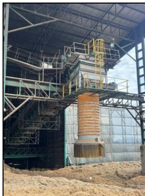
รูปที่ 5 อุปกรณ์ครอบป้องกันการฟุ้งกระจายบริเวณปลายสายพานลำเลียง
